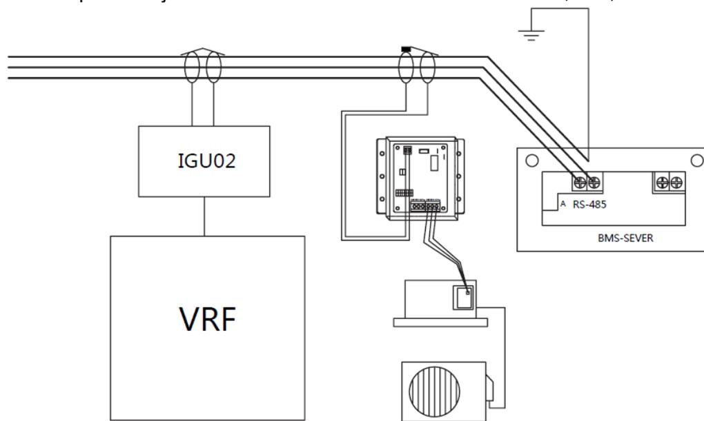
4) Hostitelské zařízení pro komunikační zařízení třetí strany poskytuje detektor standardní protokol Modbus Rtu.
