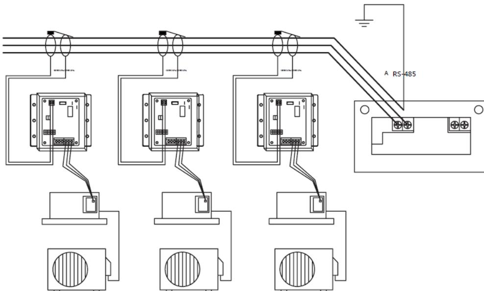
2) centrální ovladač, vyberte režim komunikace pro VRF, pak přepínač DIP je:
