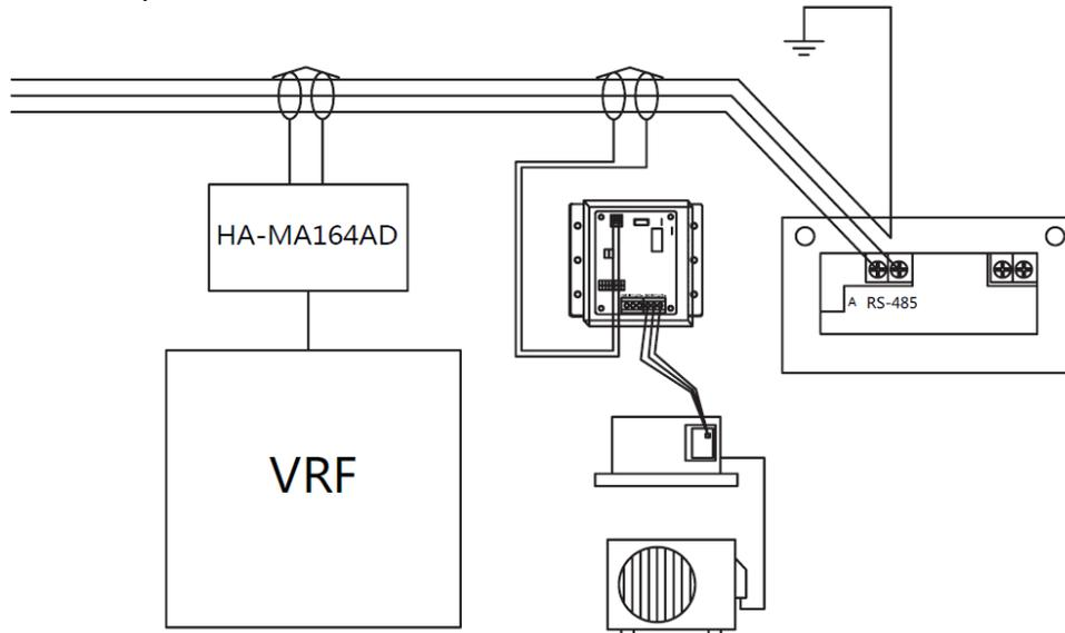
3) centrální ovladač, vyberte komunikační režim pro centrální řídicí systém (BMS), přepínač DIP: BM1-1: ON; BM1-2: ON.
