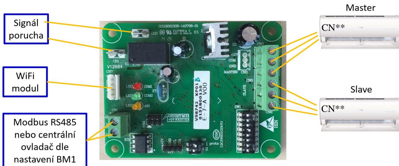
Pozn. CN\*\*: Připojovací konektor vnitřní jednotky naleznete popsán v návodu k vnitřní jednotce. U rezidenčních jednotek je to převážně číslo CN36 a u komečních jednotek dle modelu CN9 nebo CN13. Popis konektoru remote nebo central control. Možnost připojení převodníku / detektoru YCJ-A002 na konkrétní model jednotky viz servisní manuály nebo nutné ověřit kompatibilitu s kanceláří SOKRA s.r.o.
